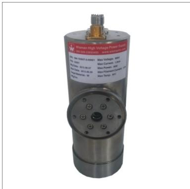
威思曼的5000系列是一个非常受欢迎的和可靠的侧窗X射线管。目前，在许多工业应用中使用，5000系列的组装在不锈钢管桶内，内衬威思曼自主研制的绝缘材料，可选择安装法兰盘。X-射线屏蔽0.25mR/hr2英寸。管内灌注威思曼自主研制的冷却油，最大限度地提高散热。
