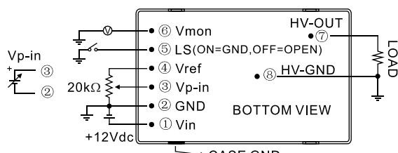
1. 管脚②和管脚⑧在内部相连接(与外壳地独立)。注：外壳必须接地。
